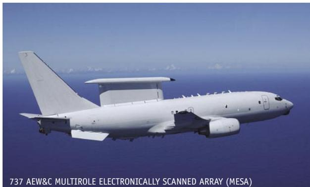
737 AEW&C MULTIROLE ELECTRONICALLY SCANNED ARRAY (MESA)
